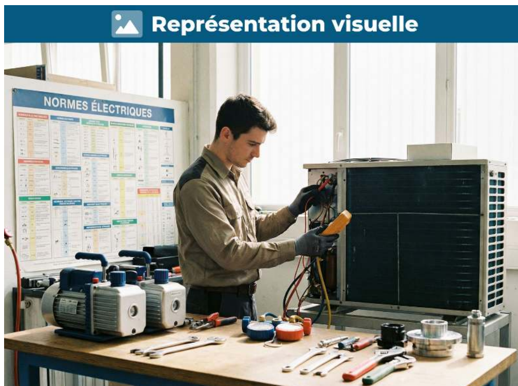
Tester les connexions électriques avec un multimètre, suivre les normes NF C 15-100
